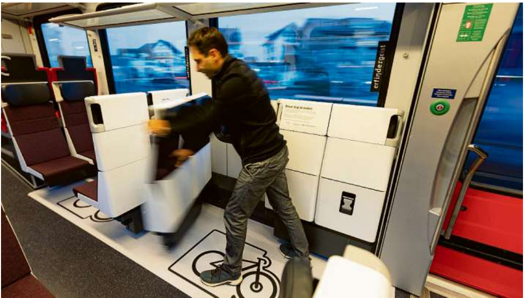
Das Pilotprojekt-Abteil: In einem Flirt-Zug der SOB gibt es für ein Jahr einen umfunktionierbaren Bereich, in dem aus Sitzplätzen je nach Bedarf Platz für sperriges Gepäck oder Velos geschaffen werden kann.
