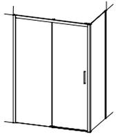
**A** Ajustar el descuadre del vidrio lateral y fijar la posición atornillándolo como se muestra
