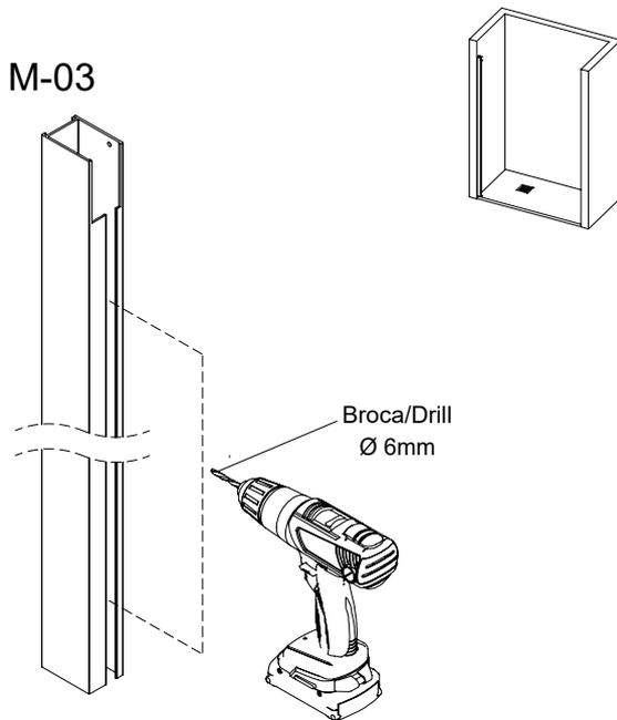
**B** Marcar los taladros del marco fijo y el exterior del perfil en la pared
