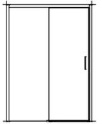
**A** Marcar el exterior del marco imán M-04 a la misma distancia del borde exterior que el marco colocado anteriormente
