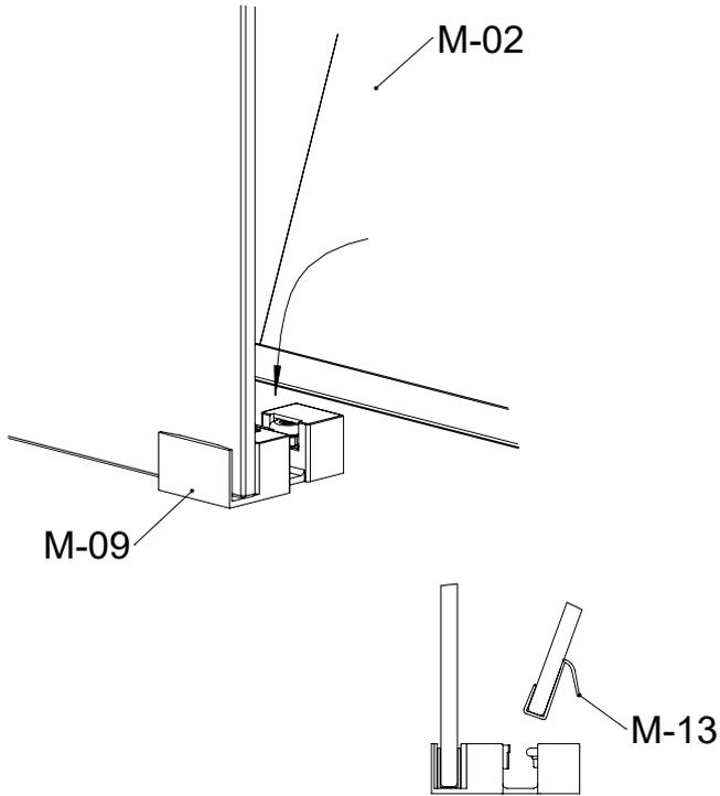
**E** Colocar los rodamientos en la guía y ensamblarlos a la hoja atornillándolo
