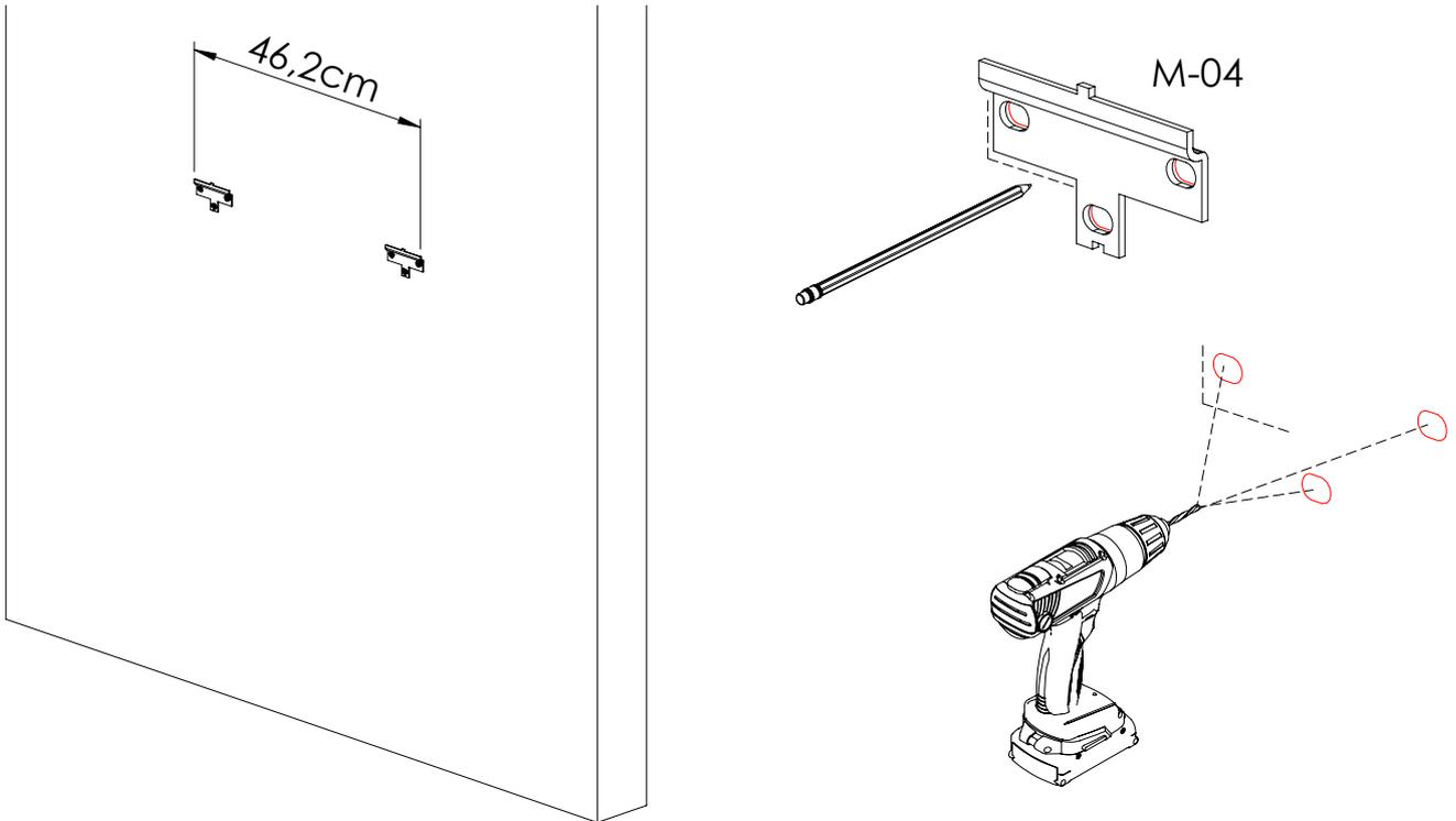
**B** Colocar los tacos en la pared y atornillar la placa
