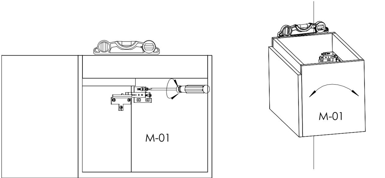
**C** Colocar silicona sobre el borde del mueble y posicionar la tapa y el lavabo
