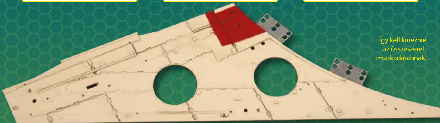
05 Rögzítsd a TP-30 lemezt a kerethez. Gondoskodj arról, hogy a hét csap a megfelelő lyukakba kerüljön.
