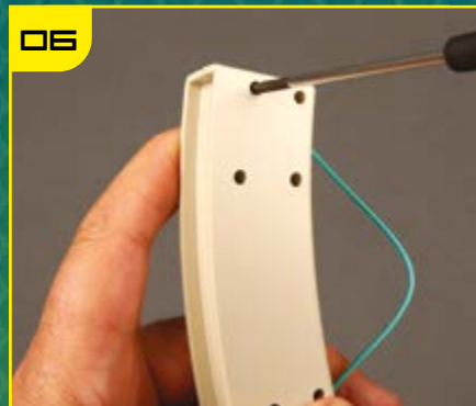
06 Kissé húzd meg a csavart, hogy a ház két felét összetartsa.
