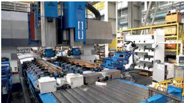
Lavorazione con testa ad angolo
