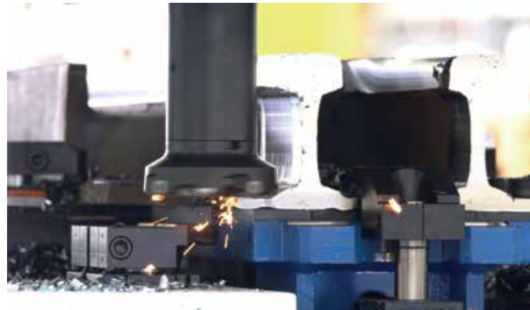
Da sinistra: staffaggi automatici sincronizzati con il ciclo di lavoro
