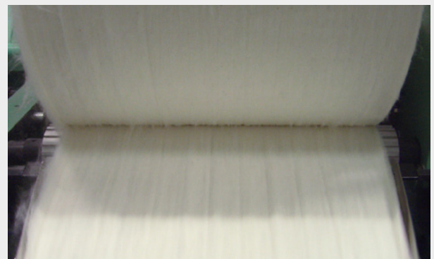
Лентосоединительная машина LW3: регулярность наложения лент для высокого качества холста
