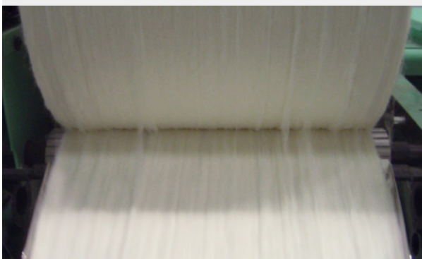
Стандартная Лентосоединительная машина: неравномерность при наложении лент
