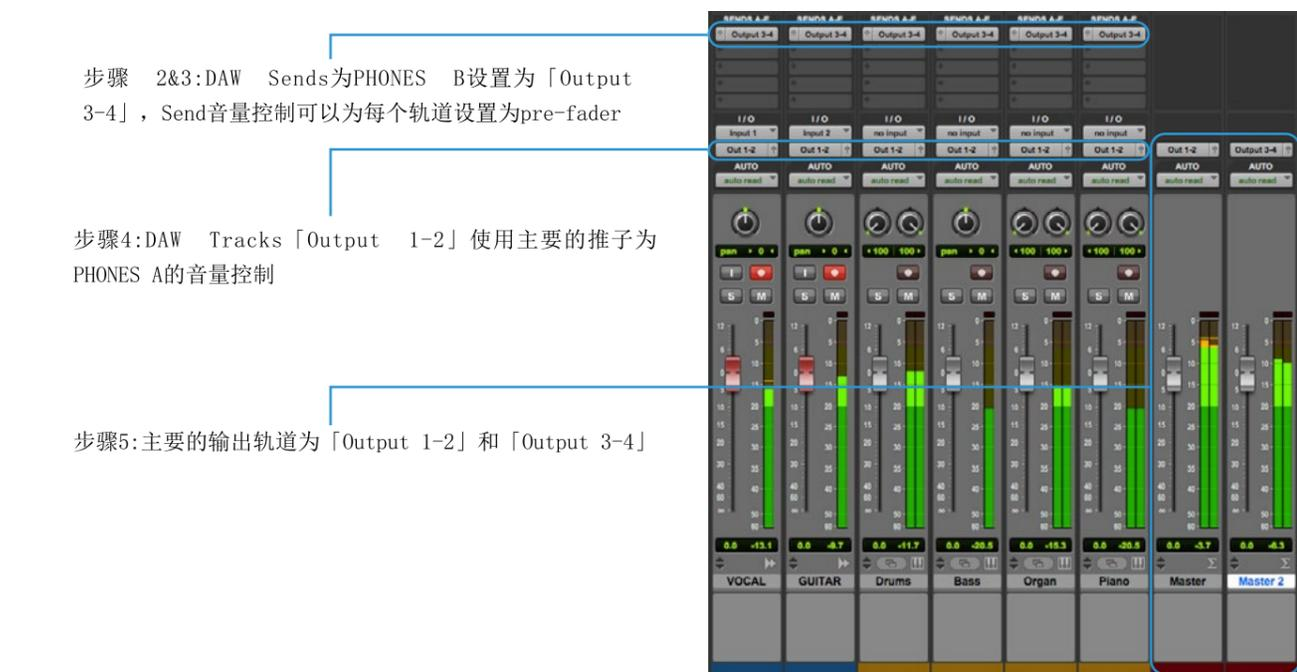
步骤 2&3:DAW Sends为PHONES B设置为「Output 3-4」，Send音量控制可以为每个轨道设置为pre-fader
