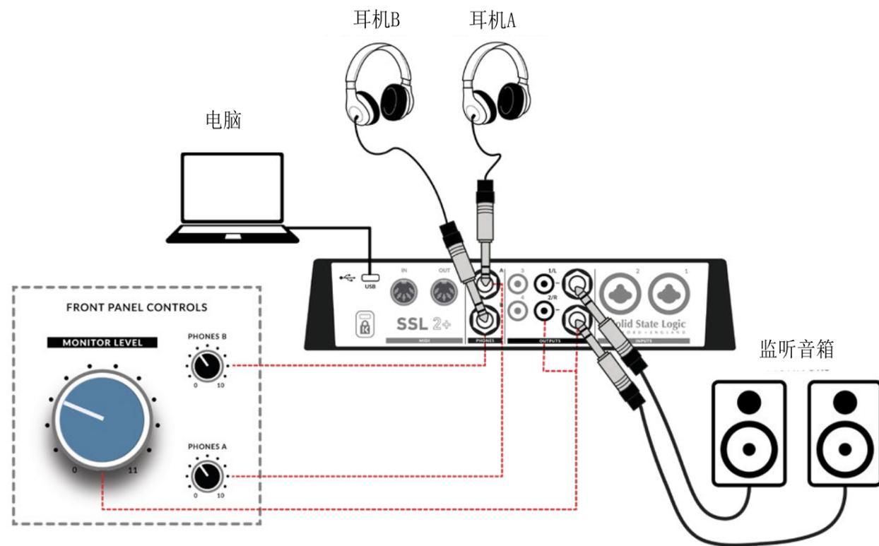
前面板那块大的MONITOR LEVEL控制器会影响平衡TRS输出L和R的音量。我们建议你将自己的监听音箱连接到这些接口上去。而且RCA接口也会收到这个控制旋钮的影响。
