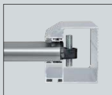
Stalowe haki przeciwwiatrowe, dostępne standardowo do bram o szerokości powyżej 7500 mm (brama rolowana)
