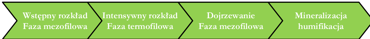
Rys. 14. Schemat poglądowy procesu kompostowania bioodpadów [opracowanie własne]
