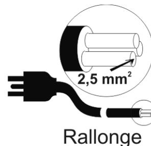
Si l'utilisation d'une rallonge électrique (longueur inférieure à 20 m) est nécessaire, n'utiliser que des câbles électriques normalisés et d'une section au moins égale à 2,5 mm<sup>2</sup> pour éviter tout échauffement ou perte de tension dans la rallonge. Pour choisir correctement la section de câble, veuillez vous référer au tableau ci-contre.
