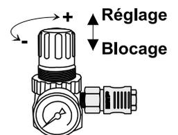
Vérifier la pression au manomètre. Lorsque la pression désirée est obtenue, bloquer le cabochon en le poussant vers le bas, ceci évite qu'il ne se dérègle à cause des vibrations.
