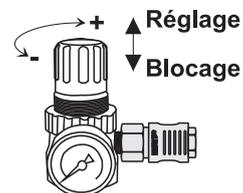
Vérifier la pression au manomètre. Lorsque la pression désirée est obtenue, bloquer le cabochon en le poussant vers le bas, ceci évite qu'il ne se dérègle à cause des vibrations.
