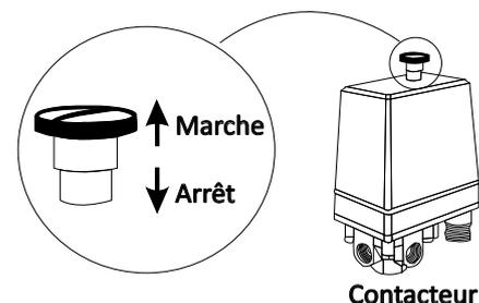
Au démarrage du compresseur, le réservoir se remplit d'air progressivement et la pression augmente. Lorsque celle-ci atteint une pression d'arrêt (réglée en usine entre 8 et 9 bars) le contacteur manométrique arrête automatiquement le compresseur.
