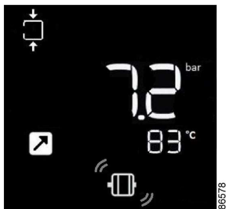
Écran principal avec indication d'arrêt, défaut du convertisseur de fréquence
