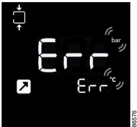
Erreur des capteurs de pression et de température
