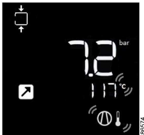
Écran principal avec arrêt de température de sortie
