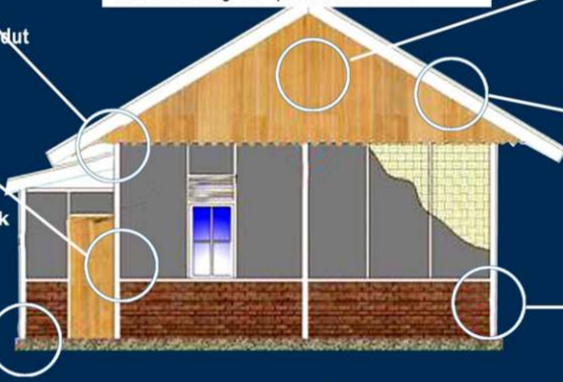
Bagian yang mengelilingi rumah pada bagian bawah terbuat dari batu bata atau batako tetapi harus ada paku yang mengkoneksikan dinding bata dengan kolom
