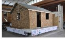
Figure 9. Essai sismique sur table vibrante, FCBA de Bordeaux, avril 2013.
