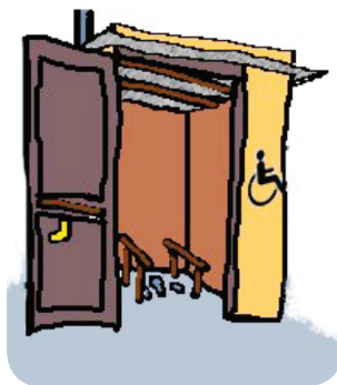
Latrina adaptada com corrimãos
