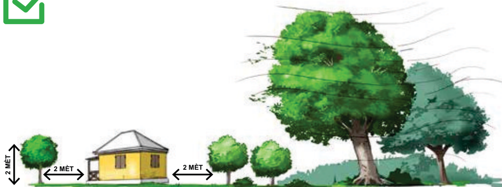
Konstwi kay la lwen gwo pye bwa yo. Konstwi Kay la plis pase 2 mètr distans pye bwa ki gen 2 mètr wotè
