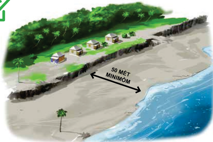
Konstwi pou pi piti 50 mètr bò lanmè (rivaj) e fòk Sòl fondasyon kay la pi wo pase nivo lanmè a
