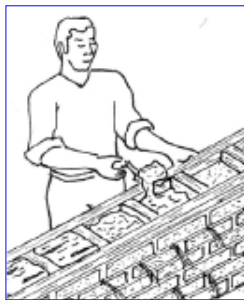
Colocación de barro entre largueros y travesaños
