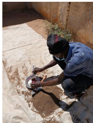
Figs 32, 33, 34, 35 and 36 – Photographies du processus de test de la terre : collecte des échantillons de sol (32), tamisage (33 et 34), malaxage (35) et préparation du test du cigare (36)
