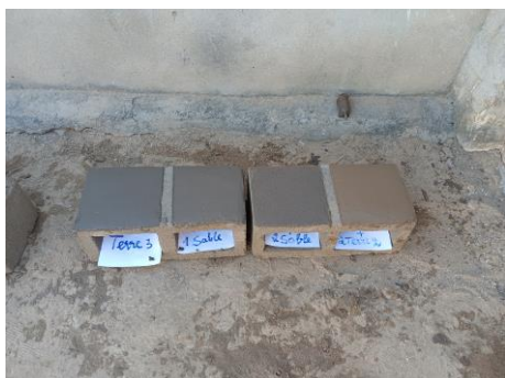
Figs 38, 39, 40, 41, 42 and 43 – Photographies des résultats des tests de terre : tests de décantation et cigare (38), tests de plaquettes (39, 40 et 41), et les premiers BTC produits avec les différents mélanges (42 et 43)
