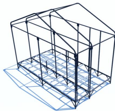
FASE 5 ARMADO DE ESTRUCTURA PARA PISO
