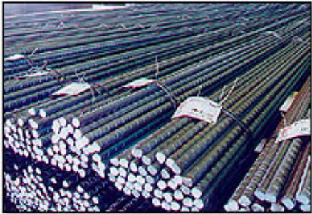
Atados de cabillas estriadas tal como se almacenan en los depósitos
