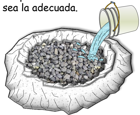
c) Agregar la grava y el agua y dejar 10 min. Mezclar todo.
