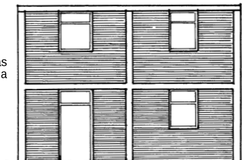
Vanos de ventanas y puertas bien ubicados
