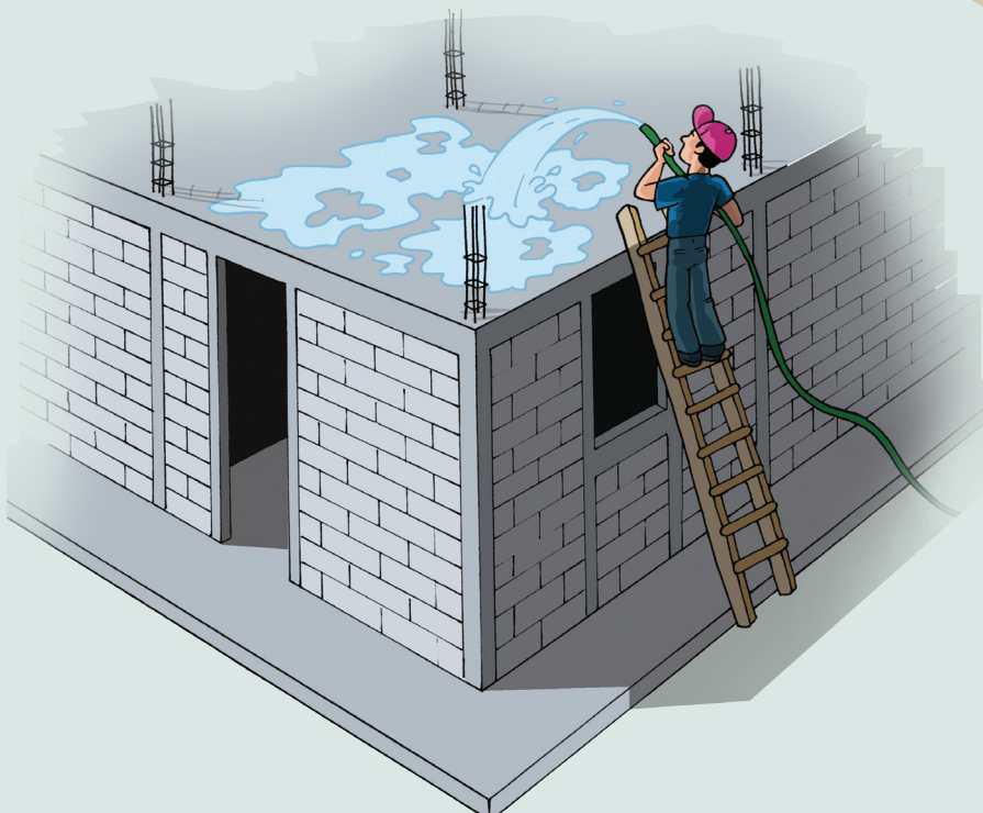
Figura 59 Curado del concreto de la losa humedeciendo con agua
