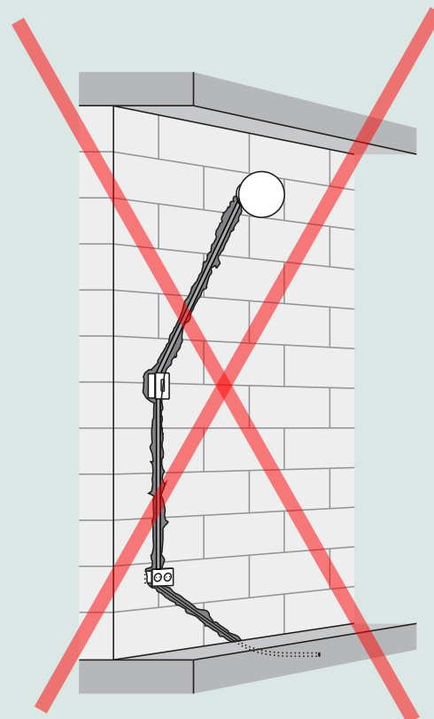
Colocación incorrecta Instalación eléctrica empotrada ranurando el muro
