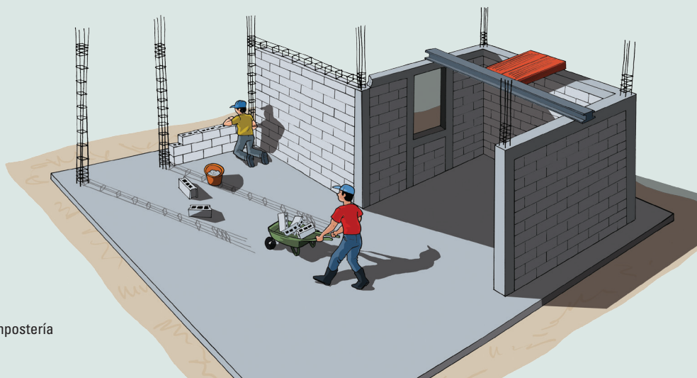
Figura 38 Proceso constructivo de muros de mampostería confinada con elementos de concreto
