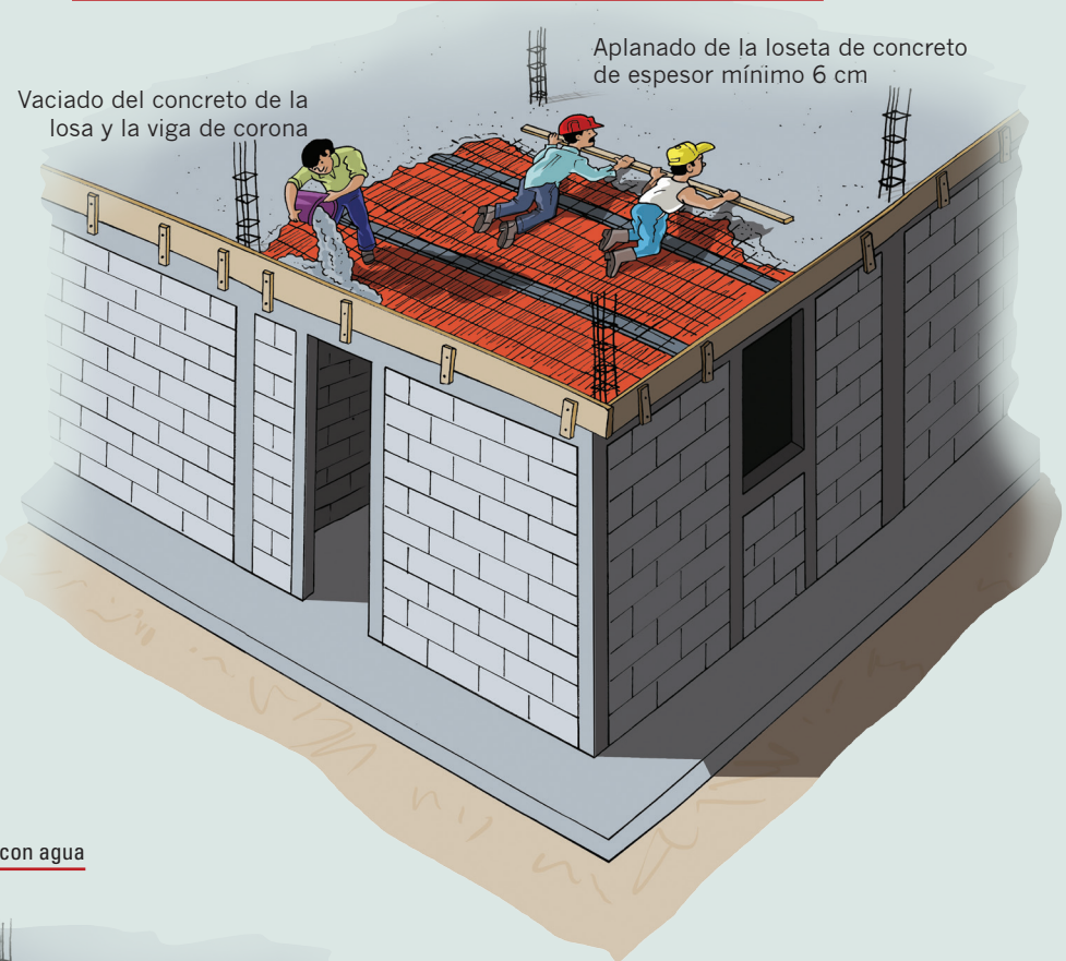
Figura 58 Vaciado y aplanado del concreto de la losa de tablonos o nervios prefabricados
