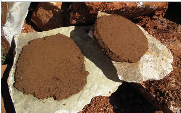
Essais de mélanges sur des pierres plates
