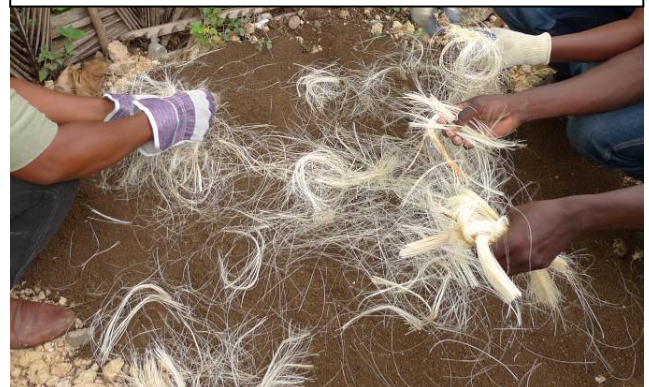
Préparation d'un mortier avec du pit
