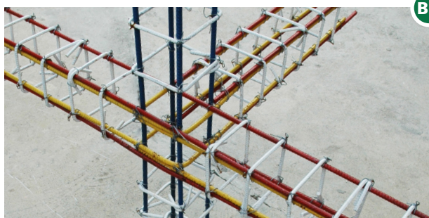
Pièce de connexion: 'L' dans une jonction en 'T'
