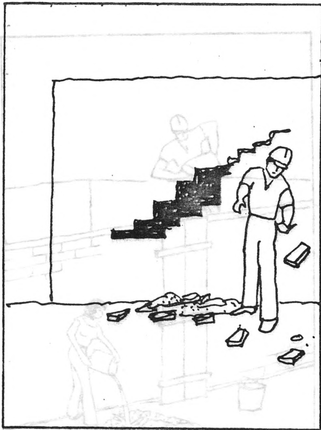
Retire los ladrillos del área marcada
