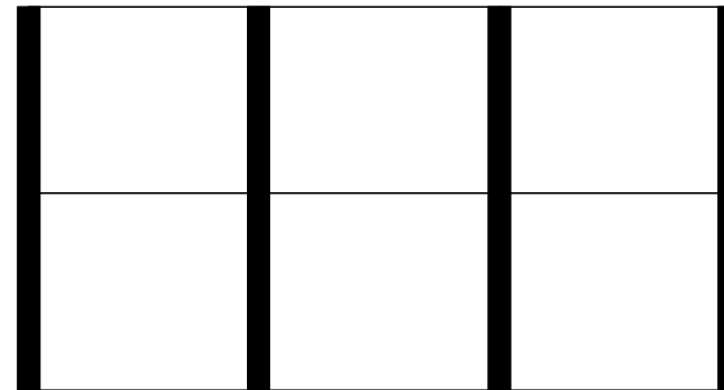
AUSENCIA DE MUROS EN UNA DIRECCIÓN
