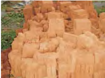
REKONSTRUKSI RUMAH PASCA GEMPA & TSUNAMI ACEH, 26 DESEMBER 2004 CONTOH MUTU BAHAN YANG RENDAH
