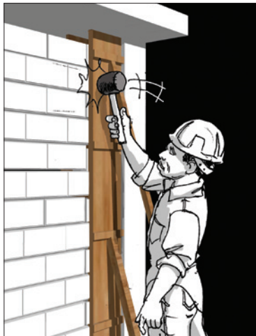
4. Vider le béton par couche et le faire vibrer/ou le tasser avec une tige de fer après chaque couche.
