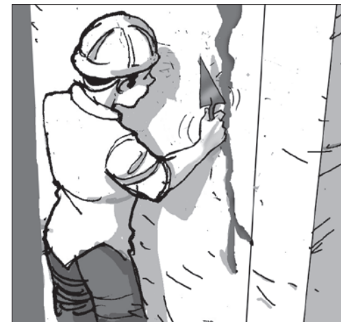
6. Fissure sur la maçonnerie proche de la colonne de béton, du plafond ou du plancher
