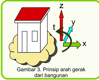
Gambar 2. Gaya inersia dan gerak relatif pada bangunan
