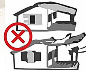
Fig.4 Nunca unir la estructura de cubierta del portal, colgadizo o terrazas al resto de la vivienda
