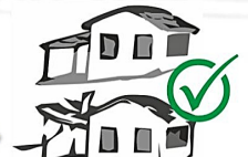
Fig.4 Nunca unir la estructura de cubierta del portal, colgadizo o terrazas al resto de la vivienda
