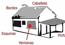
Fig.6 Puntos vulnerables de la vivienda
