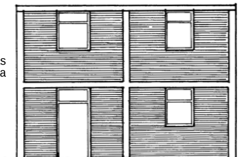
Vanos de ventanas y puertas bien ubicados
