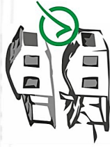
Fig. 5 Los sobertizos o portales adosados construidos independientes a las cubiertas disminuyen la vulnerabilidad de la misma ante la acción de fuertes vientos
