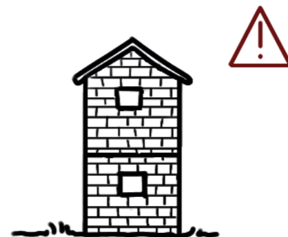
Cobertura liviana y 2 pisos pesados (tipo albañilería).
