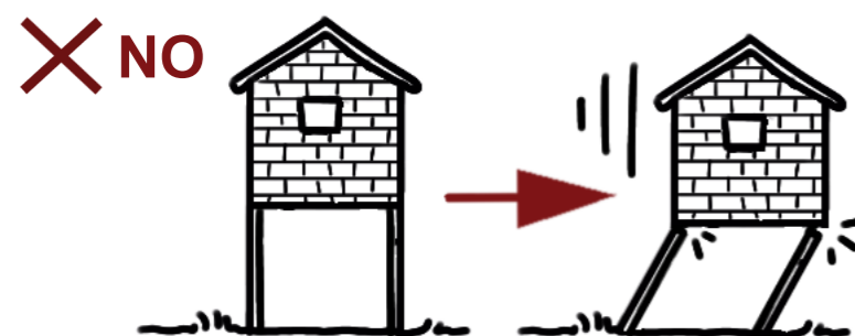
Casa pesada sobre pilares livianos o sobre pilares de hormigón subestándar (piso blando). ¡Hay riesgo de ruptura de los pilares!
