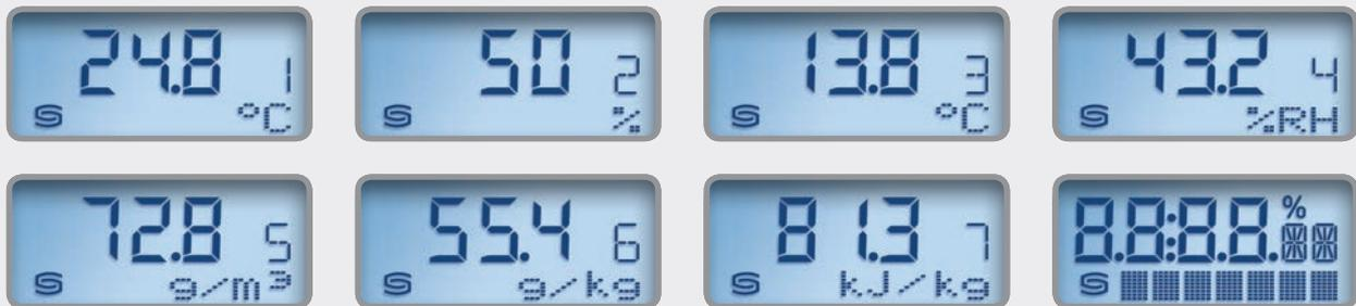
El valor de indicación depende del sistema de unidades ajustado. Estandarizadamente, en el display se visualizan alternativamente la **temperatura efectiva** y la **humedad efectiva** (humedad relativa).
