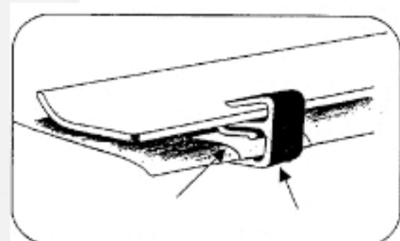
Klicka fast plastclipset med den plana delen mot huvskyddet (i profil syns en liten pigg, som skall fästas i huvskyddets borrade hål). Den tandade delen monteras runt motorhuven.
