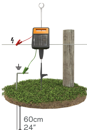
Puesta a tierra para el Paso 3 (a. b. c.)
