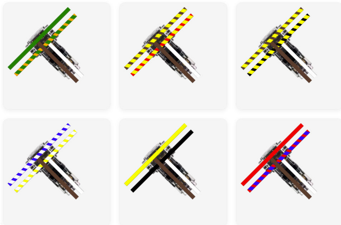
Figur 1:1: Olika kabelfärger som förekommer. Tänk på att kablarna alltid är ihoptvistade.
