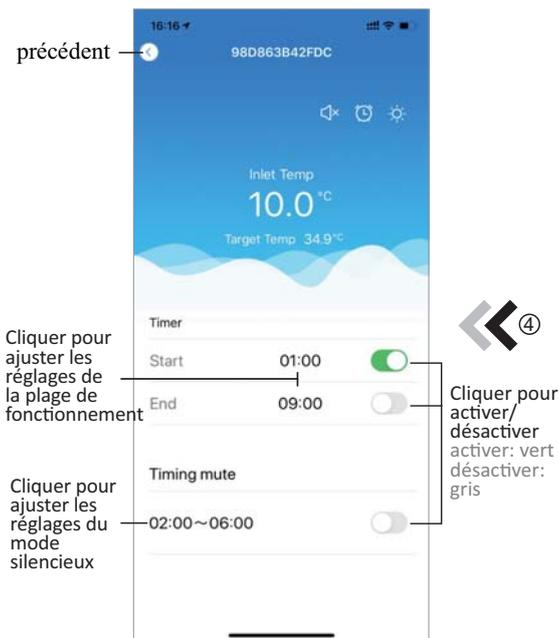
Fig.21 Interface de Réglage du Chronométrage
