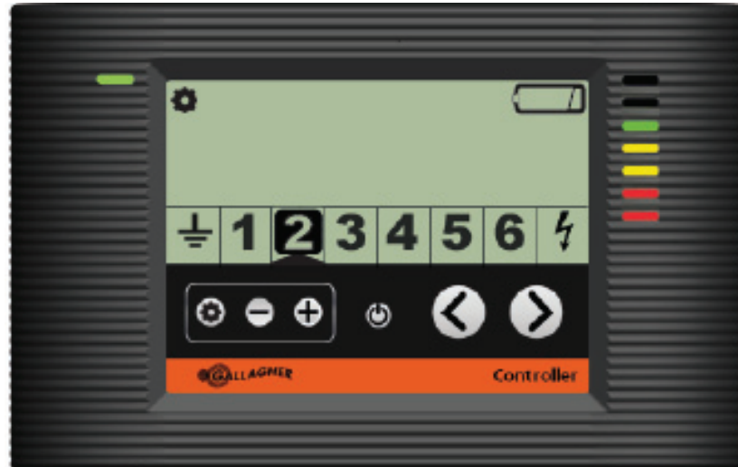
Kontroll visar zon 2 med en låg batterinivå
