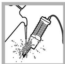
**11.** Lavare la sonda con acqua deionizzata. Asciugare la sonda con un panno privo di lanugine.
