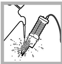
3. Lavare la sonda con acqua deionizzata. Asciugare la sonda con un panno privo di lanugine.
