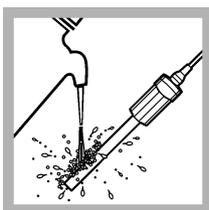
3. Lavare la sonda con acqua deionizzata e con il campione. Asciugare con un panno privo di sfilacciate.
