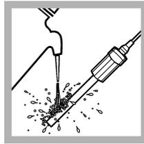
4. Lavare la sonda con acqua deionizzata. Asciugare con un panno privo di sfilacciature.
