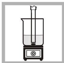
7. Posizionare il becher su un agitatore elettromagnetico e agitarlo a una velocità moderata. Controllare l'eventuale presenza di bolle d'aria e, se necessario, rimuoverle.
