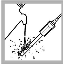
3. Sciacquare la sonda con acqua deionizzata e. Asciugare con un panno che non rilascia pelucchi.
