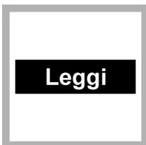
8. Selezionare **Leggi**. Il display evidenzierà il valore standard e passerà al valore standard successivo. Il display mostrerà il messaggio "Stabilizzazione in corso..." e una barra di avanzamento mentre la lettura si stabilizza. Il display mostra il valore standard quando la lettura è stabile.
