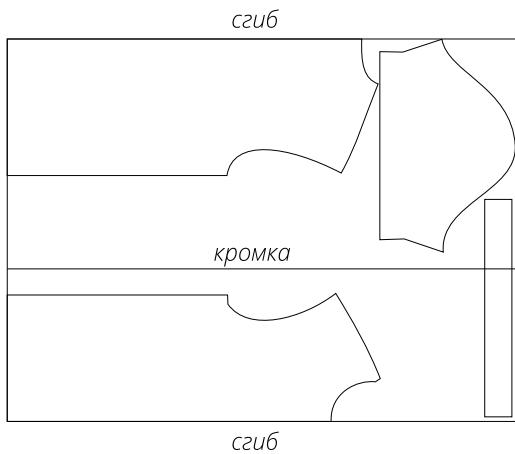
План раскладки выкройки на основном материале шириной 180 см для раскroя в два сгиба для 52-54 размеров всех ростов в одном направлении (в двух частях)
