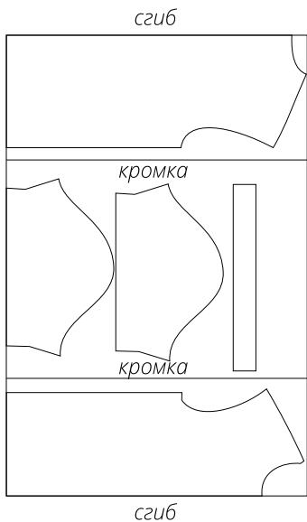
План раскладки выкройки на основном материале шириной 180 см для раскroя в два сгиба для 42-50 размеров всех ростов в одном направлении
