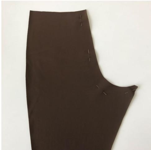
Сложить детали задних половинок лицевыми сторонами внутрь, совместить шов сиденья, контрольные надсечки, сколоть булавками. При необходимости сметать ручными стежками. Наметочную строчку следует прокладывать очень тонкой иглой, светлыми нитками (во избежание окрашивания ткани при ВТО), на расстоянии 1,2-1,5 см от края среза во избежание попадания в строчку наметочной нитки.
