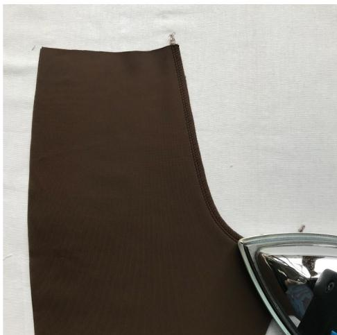
Выполнить ВТО (влажно-тепловую обработку) изделия. Приутюжить припуск.
