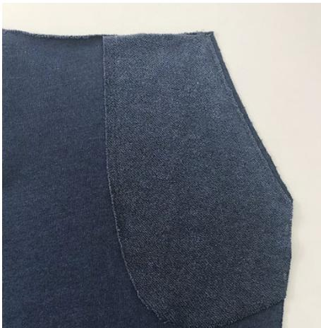
Подрезать припуск шва притачивания мешковины кармана по передней половинке брюк на 0,5 см от края.
